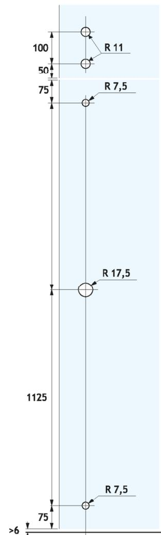
Coppia di maniglioni a barra sezione rotonda con serratura incorporata a pavimento per porte in vetro
